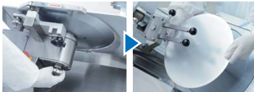
ノブを緩めるだけで丸刃中カバーが脱着でき、都度の高さ調整も不要。
