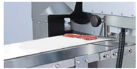
断面積が一回毎に変わる不定形肉を同重量にスライス配列
