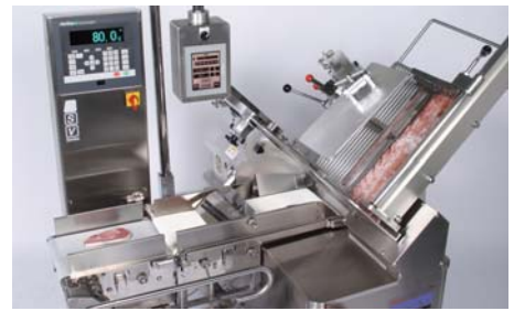
設定した一定重量に±5%の精度でスライス
